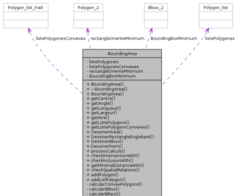
FIG. 4.8 – Modélisation UML - Classe BoundingBoxArea
